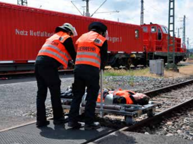
Bild li.: Mit Rollwagen können Geräte oder Verletzte auf den Schienen transportiert werden; Bild re.: An zwei Funkarbeitsplätzen wird die komplette Kommunikation mit den Rettungseinheiten abgewickelt.
