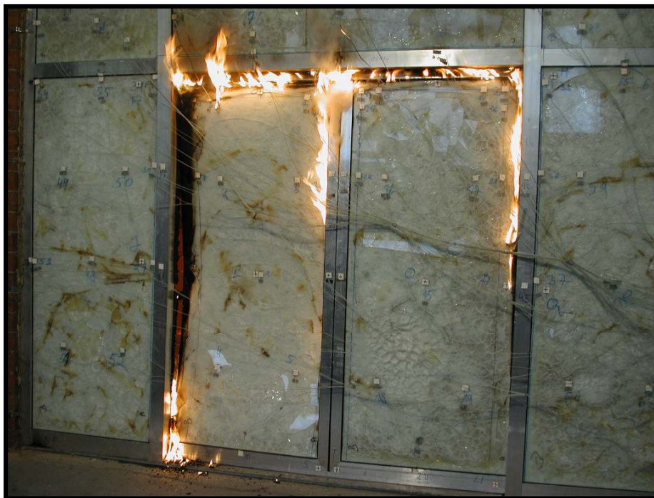
Brandprüfung einer Feuerschutztür T 30-2 mit Seitenteilen und Oberlicht
