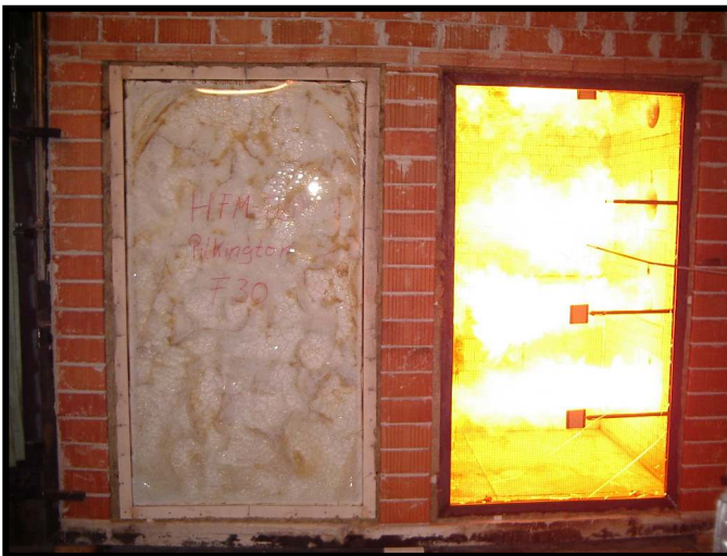
Brandprüfung mit Brandschutzverglasungen F 30 (links) und G 30 (rechts)
